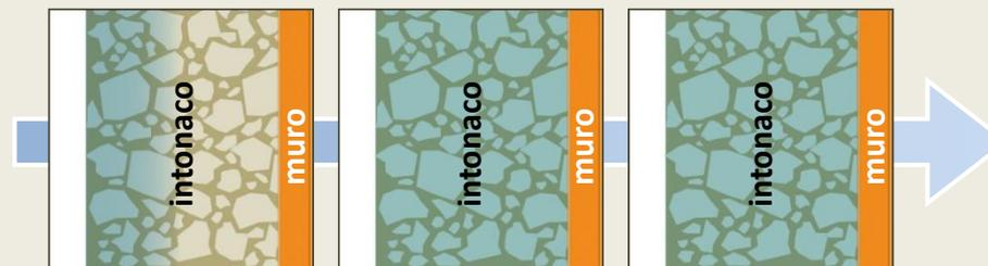
In questo caso al passaggio del vapore acqueo l'inerte carbonato di calcio si impregna d'acqua rimanendo bagnato nel tempo. Tale fenomeno oltre ad essere soggetto all'attacco di muffe, funghi e degrado, annulla il potere traspirante e isolante dell'intonaco. È **perciò corretto dire che per avere intonaci che respirano non bastano calci che lasciano traspirare, ma occorrono sabbie non assorbenti.**
