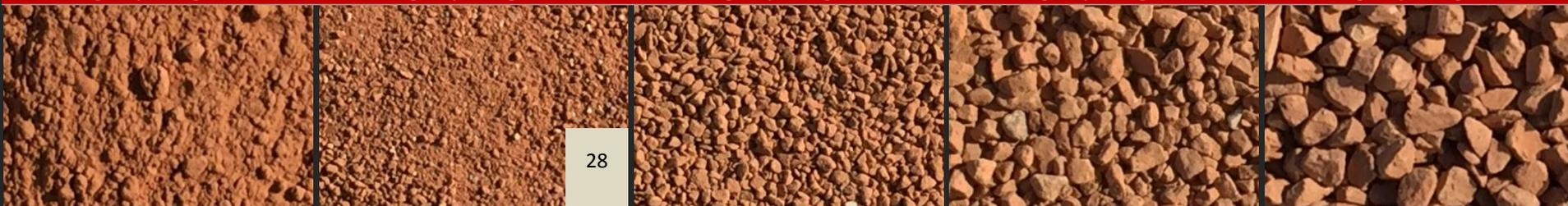
Polvere finissima a reattività certificata (EN 197-1) e inerte leggero certificato (EN 13055) ottenute da cocci di soli coppi gialli essiccati, frantumati, selezionati e depolverizzati; particolarmente indicato per la preparazione di malte in cantiere sia per interventi in bio edilizia nel rispetto della natura secondo antiche tradizioni italiane, sia per restauri di edifici storici tutelati dalla Soprintendenza per i Beni Culturali.
