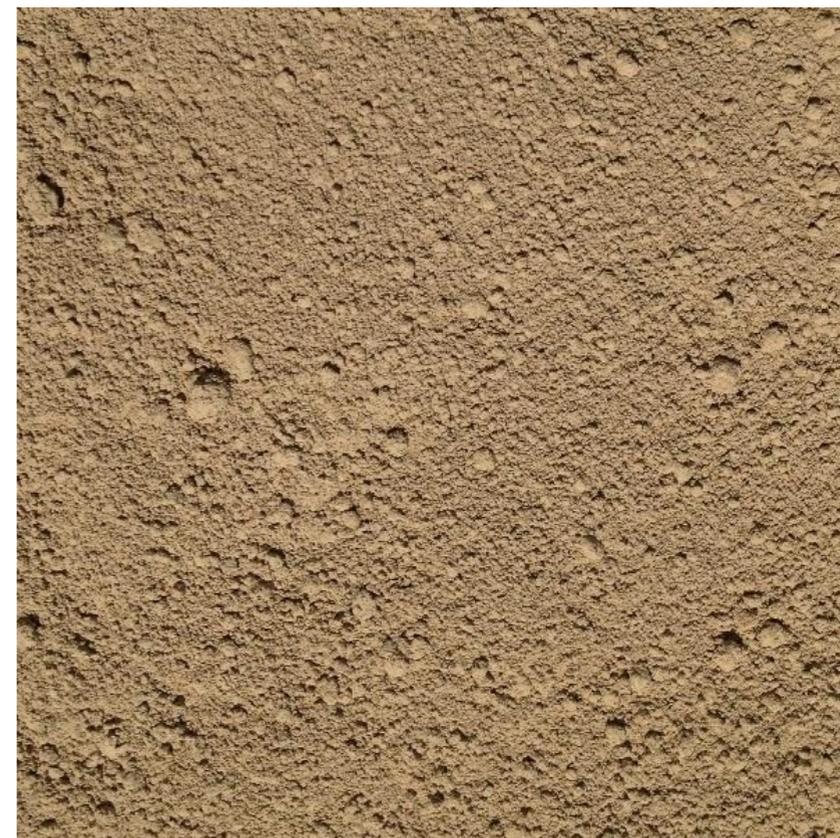
La **calce idraulica naturale NHL** (natural hydraulic lime) è un legante ottenuto dalla lavorazione di una marna calcarea senza l'aggiunta di altri componenti. Viene cotta in forni verticali ad una temperatura fra 1000° e 1150° C e dopo un'adeguata perdita di volume, segno di una corretta cottura, le pietre vengono idratate utilizzando la quantità di acqua necessaria; né troppa che causerebbe la diminuzione della forza della calce, né poca che potrebbe bruciarla.
